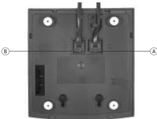
Afbeelding 1: Toestelaansluitsnoer en adaptersnoer aansluiten op basisstation.
